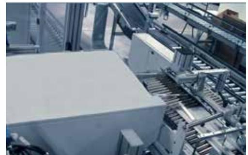
El inserter de documentos asegura la sincronización uniforme de los mismos. Las cajas de diferentes alturas se llenan automáticamente.
