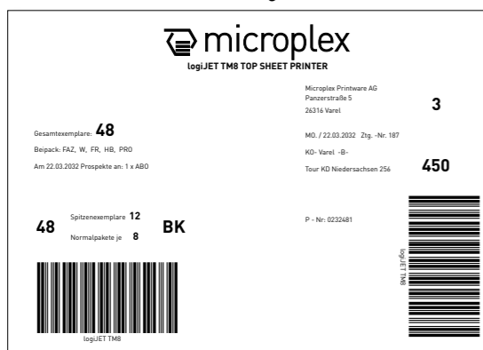
Feuille de couverture typique pour des piles de journaux au format A4
