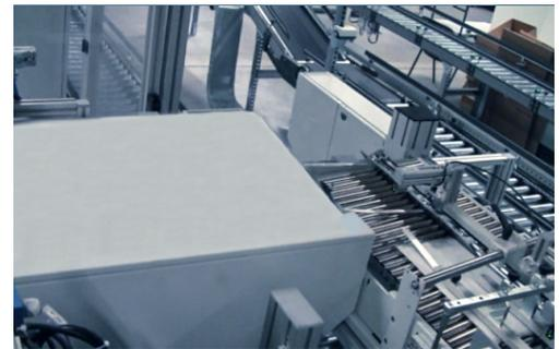
Der Dokumenteneinleger sorgt dafür, dass die Dokumente gleichmäßig synchronisiert werden. Kisten unterschiedlicher Höhe können automatisch befüllt werden.
